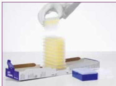
② Sollevare il coperchio di trasferimento - I puntali sono protetti.
