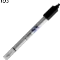
2301 T Cella di conducibilità in epoxy, C=1 sensore di temperatura incorporato, cavo fisso 1 m. Campo di lavoro 10 \mu S...200 mS cod: 50004002
