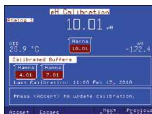
Calibrazione pH fino a 5 punti con riconoscimento automatico del tampone
