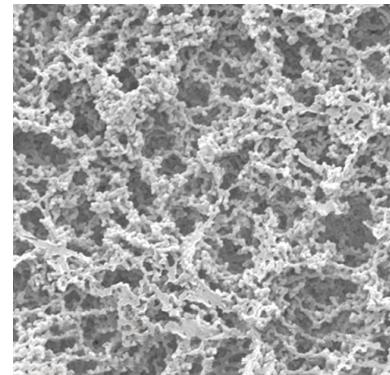
La membrana di filtrazione Mixed Cellulose Esters (MCE) è una membrana idrofila non supportata.
