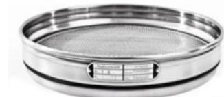
Setacci di misura in acciaio inossidabile con diametro Ø 200 x25 mm
