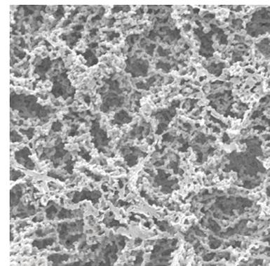
La membrana di filtrazione Mixed Cellulose Esters (MCE) è una membrana idrofila non supportata.
