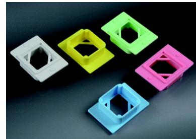
Anelli per inclusione realizzati in ABS, molto resistenti al calore ed alle alte compressioni.
