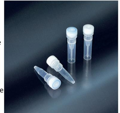
Autoclavabili, centrifugabili ad una R.C.F massima 25.000 x g (16.400 R.P.M.). Dispositivo Latex-free.
