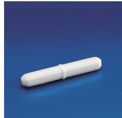
Ancorette magnetiche di forma cilindrica con anello centrale.
