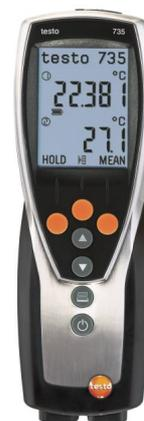
Inoltre è predisposto per il trasferimento via radio dei dati. Con il modulo radio opzionale, il mod. 735-1 è in grado di ricevere i valori di misura trasmessi da tre ulteriori sonde radio.
