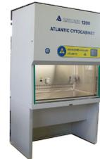
È una cabina a flusso laminare verticale di classe **II tipo H**, con apertura frontale attraverso la quale l'operatore può lavorare all'interno della camera di lavoro e che è progettata e costruita per proteggere l'operatore, aumentare la protezione del prodotto da contaminazioni esterne, e per diminuire al massimo i rischi biologici per l'ambiente. Tutto ciò è reso possibile dalla tripla filtrazione assoluta (filtri hepa).
