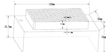
Dotato di un foro filettato per poter inserire l'astina con il relativo pomello per la rimozione del blocco dallo strumento (ogni singolo blocco è dotato dell'astina)
